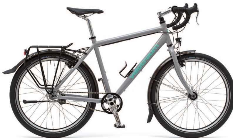
VK-9 mit »cross 7005 EX« Rahmen, Rennlenker mit Co-Motion Drehschalthebel für Rohloff. Rahmengröße: »L«, Gewicht: 14,6 Kilogramm, Farbe: RAL 7004
